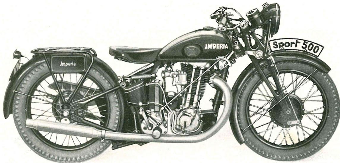
**Motor:** 1 Zyl.-Viertakt-Sportmotor mit 2 hängenden Ventilen im abnehmbaren Zylinderkopf vollgekapselt. Einfacher, großer Auspuff. Hubraum: 499 ccm, Bohrung: 84 mm, Hub: 90 mm. Trockensumpf-Umlauf-Schmierung, gute Oelkühlung durch getrennt angeordneten großen Oelbehälter (3 Ltr.). Amal-Vergaser. Leistung: ca. 18 PS.
