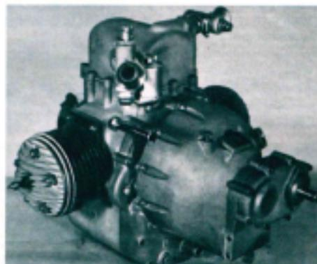
Die Maschine verfügte über ein angeblocktes, vollautomatisches TRILOK-Strömungsgetriebe und eine Kardanwelle zum Hinterrad.
