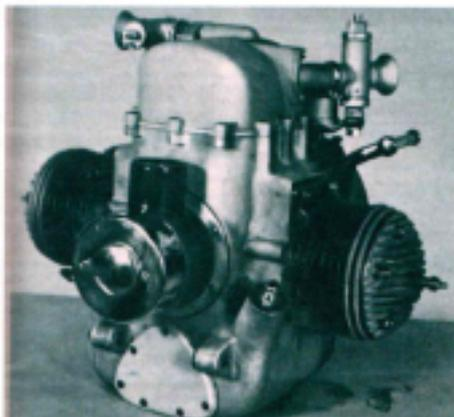
Der Boxer leistete mit Gebläseauffadung 27 PS bei 5.000 U/min.
