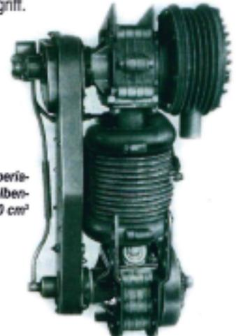
Imperia-Gegenkolben-Rennmotor 350 cm<sup>3</sup>
