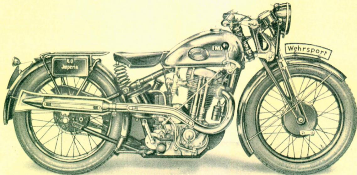
**Motor.** 1 Zyl.-Viertakt-Sportmotor mit 2 hängenden Ventilen im abnehmbaren Aluminium-Bronze-Cylinderkopf, vollgekapstelt. Einfacher, großer Auspuff. Hubraum: 346 ccm, Bohrung: 70 mm, Hub: 90,5 mm. Trockensumpf-Umlaufschmierung, gute Oelkühlung durch getrennt angeordneten großen Oelbehälter (3 Ltr.). Amal-Vergaser. Motor gegen Steinschlag durch Stahlblech-Mulde gut geschützt. Leistung: ca. 18 PS.
