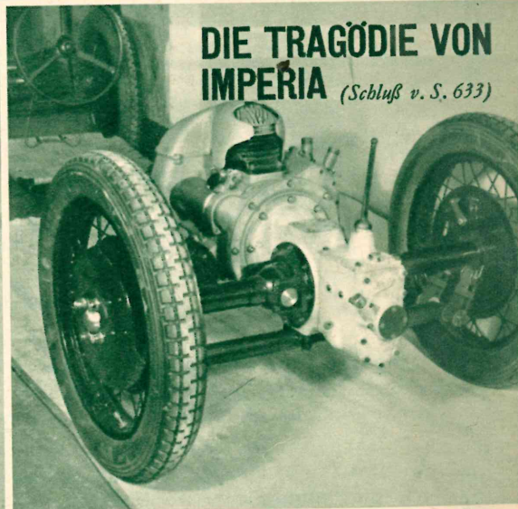
Links der Rennsportwagen mit der von König-Fachsenfeld entwickelten Stromformkarosserie, rechts der Triebwerksblock mit den Halbwellen für den Hinterradantrieb und der Gummifederung für die einzeln aufgehängten Räder, unten ein Blick auf den gebälsegekühlten Dreizylinder-Zweitaktmotor, der das Serientriebwerk für verschiedene Varianten dieses Fahrzeuges bilden sollte.
